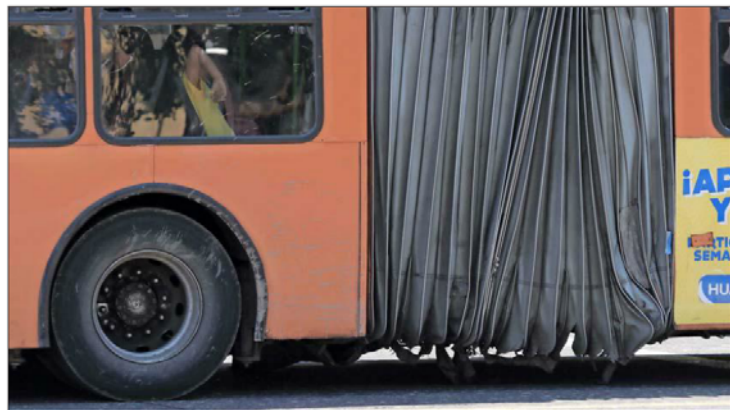
FLOTA ANTIGUA. — De los 1.246 buses de la firma colombiana, 530 (42,5%) fueron comprados entre 2005 y 2006, y ya han cumplido su vida útil, con más de un millón de km recorridos. La mayoría son articulados, con fuelles dañados.
